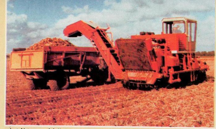
● شكل رقم (١) : حصاد درناات البطاطا بعد قتل المجموع الخضري ميكانيكياً
